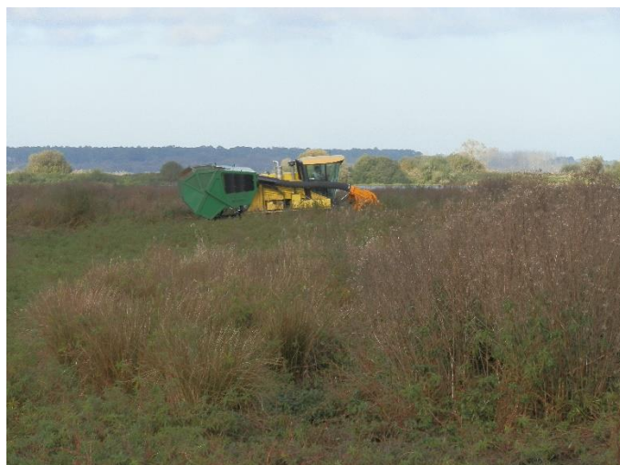
Zone de jussie sur la Marais Barrage traitée à l'aide d'un engin mécanique amphibie sur chenilles
